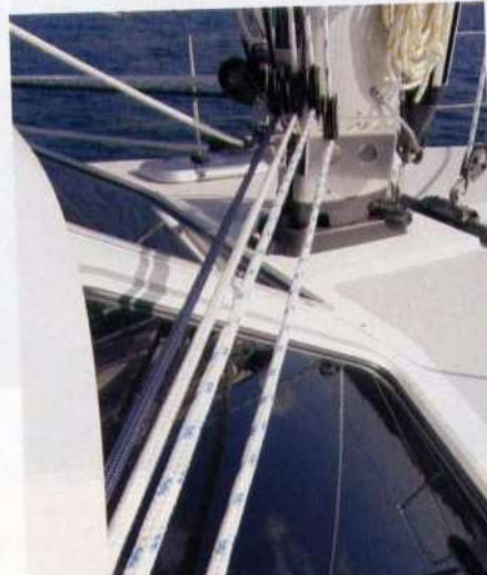
Sopra, la parte frontale della tuga ospita la rotaia del fiocco autovirante e due maniche a vento. Sotto, le drizze si incuneano sotto la deck house e fuoriescono a lato della ruota.
