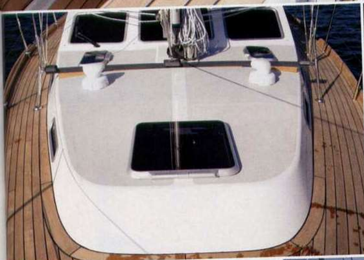
Sopra, la parte frontale della tuga ospita la rotaia del fiocco autovirante e due maniche a vento. Sotto, le drizze si incuneano sotto la deck house e fuoriescono a lato della ruota.
